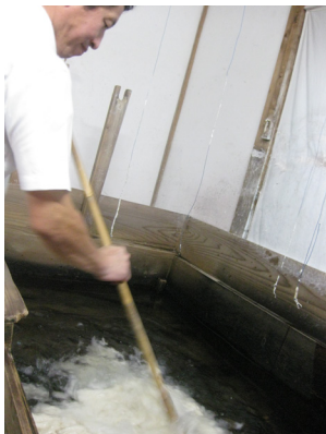
Pasan por la pila Holandesa para separar las fibras
