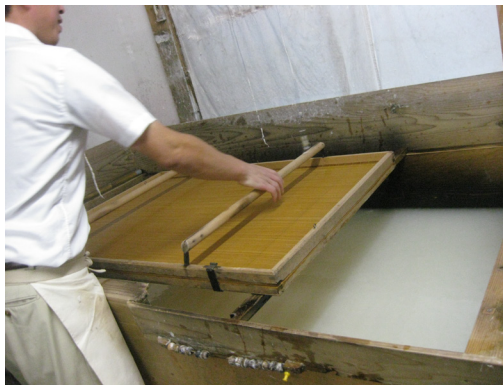
La mezcla es agregada y batida en agua, con adhesivos vegetales, listo para elabora hojas de papel.
